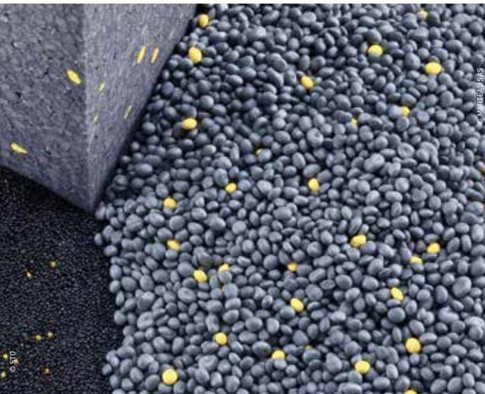
▲ LES ISOLANTS EN POLYSTYRÈNE EXPANSÉ (PSE) SONT FABRIQUÉS À PARTIR DE BILLES DE POLYSTYRÈNE EXPANSIBLES, OBTENUES PAR POLYMÉRISATION DES GOUTTES DE STYRÈNE SOUS L'EFFET DE LA VAPEUR D'EAU ET EN PRÉSENCE D'UN AGENT D'EXPANSION, LE PENTANE.
